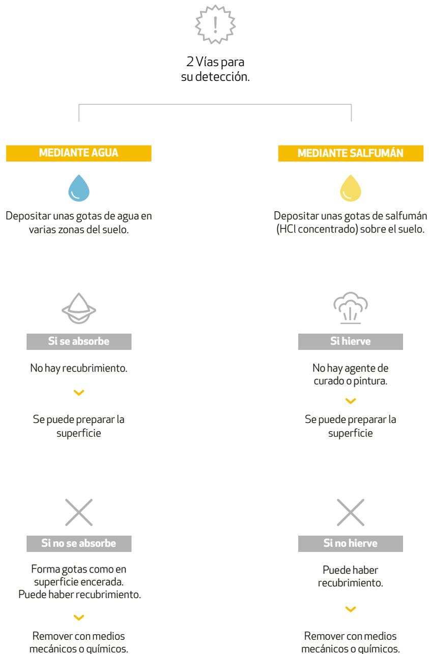
ⓘ En caso de detectar falta de cohesión en el soporte, Isaval recomienda realizar las mediciones de resistencia a la compresión y a la tracción:
